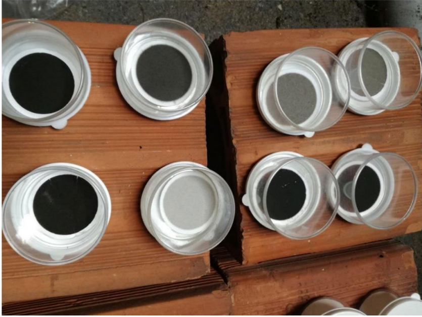
Şekil 5. Çatalağzı'nda gerçekleştirilen hava kalitesi ölçümlerinde kullanılan PM 10 ve PM 2.5 filtrelerinin durumu (TMMOB ÇMO, 2018)
