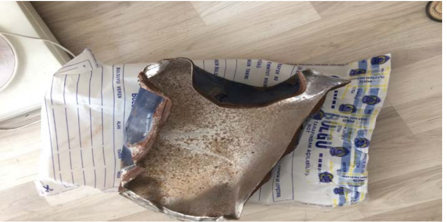
Şekil 1: Patlama sonrası varil kapağının durumu
