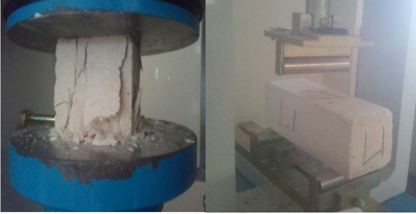
Şekil 1: Basınç ve Eğilme preslerindeki numune örnekleri.
