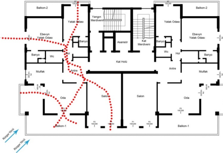
Şekil 9. Durum 3 pencere açıklıkları ve rüzgâr yönü
