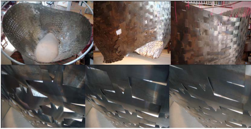
Şekil 14. Kendi kendini havalandırabilen ( self-ventilating ) akıllı termobimetal prototipi ve farklı sıcaklıklara yüzeyin verdiği tepkileri gösteren performans deneyleri (Sung, 2010)
