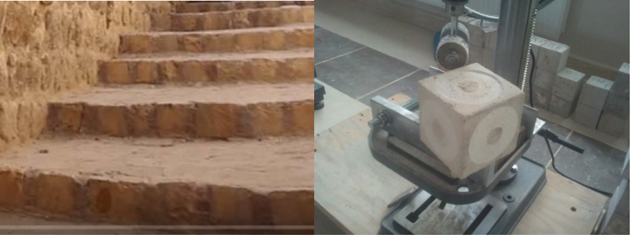
Şekil 3.12: Mardin Taşının zeminde kullanımı ve Kullanılan Aşınma Deneyi Cihazı.
