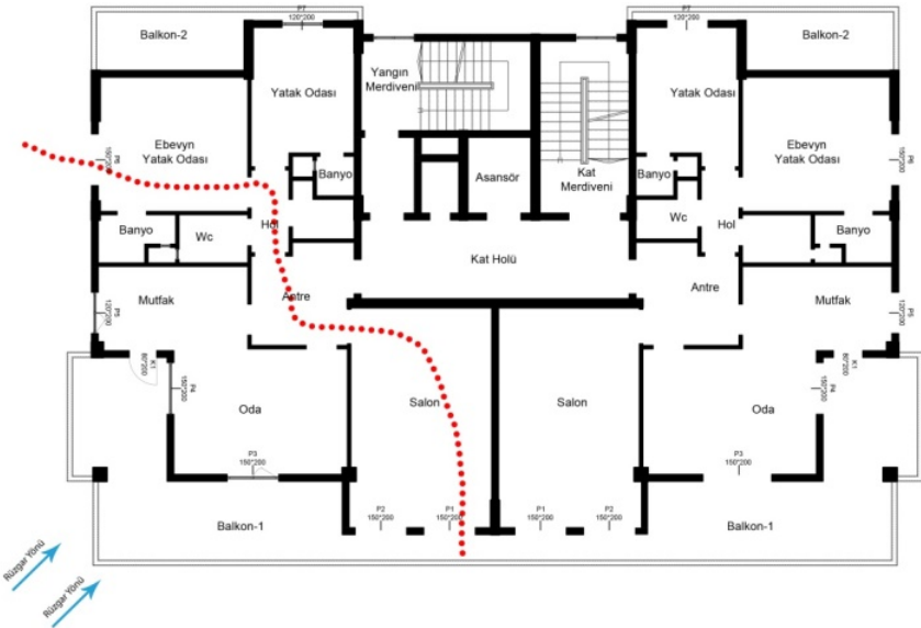
Şekil 7. Durum 2 için pencere açıklıkları ve rüzgâr yönü
