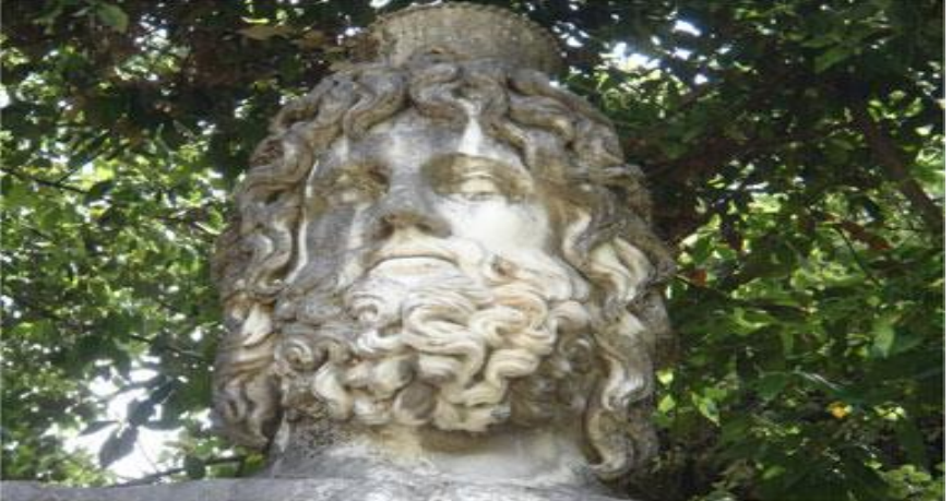
Şekil 3. Mantar ve likenlerin neden olduğu siyah renklere sahip beyaz Carrara mermerinden heykel; Boboli Parkı, Floransa, İtalya (Fotoğraf: Sterflinger).
