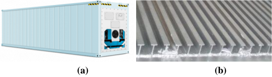
Şekil 9. Soğutmalı konteynerlerin 16 ; a) birim görünüşü, b) döşeme sistemi
