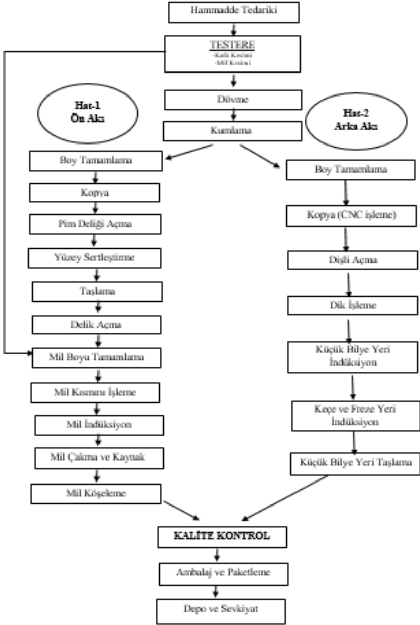
Şekil 14. MF Grubu Traktörlerin İş Akış Şeması
