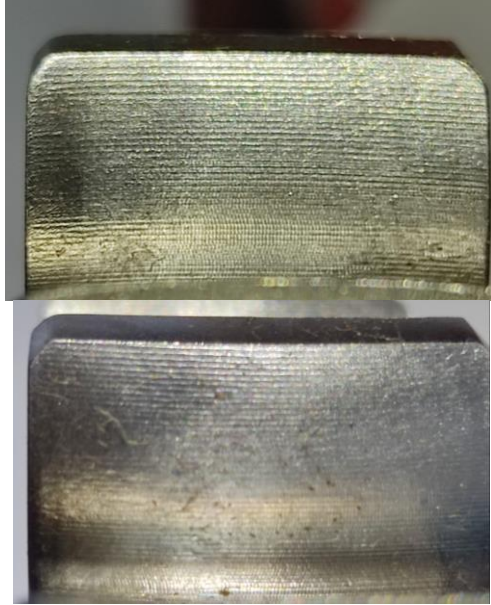
Şekil 8: CNC tezgahında üretilmiş konkav-konveks evolvent diş yüzeyleri
