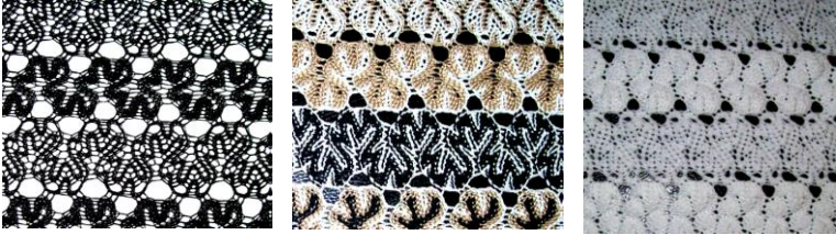
Şekil 12: Farklı İpliklerde Raşel Örmeye Makinesinde Elde Edilen Kumaş Örnekleri (Özkendirci,2010:166)
