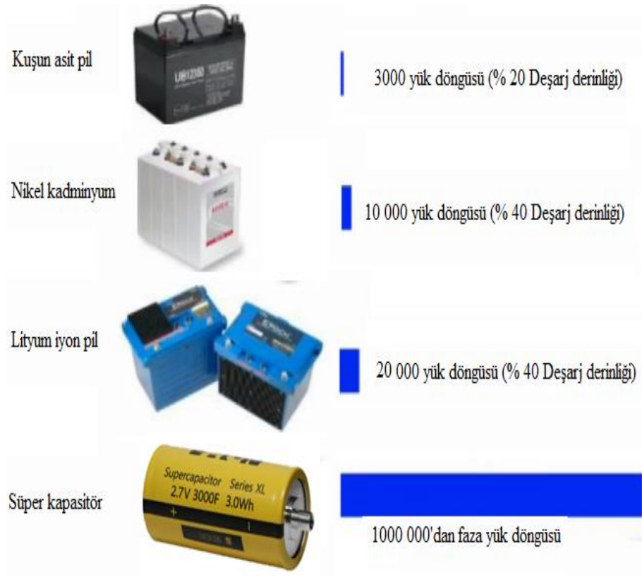
Şekil 4.7: Süper Kapasitör ve Pilerin Yük Döngüsü Açısından Karşılaştırılması
