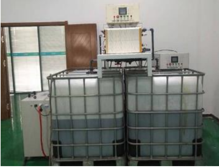
Şekil 3.9: Vanadyum Redoks Akış Pili'nin Bütün Sistemi
