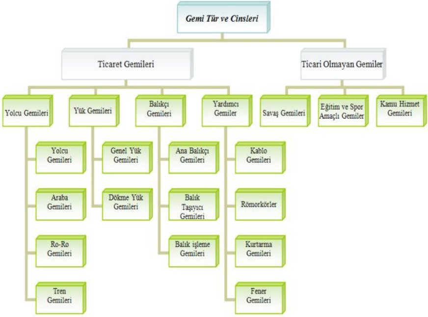
Şekil 2. Hukuki ve Taşıdığı Yüke Göre Gemi Tür ve Tipleri (Kaynak: Daştan ve Erol, 2015: 38)
