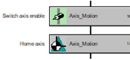
Şekil 3.18: MCC Enable ve Home Program Komutları
