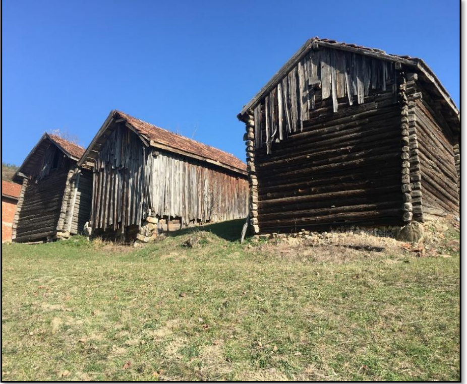
Fotoğraf 50. Karaboğaz Geçme Yöntemi İle Yapılmış Ahşap Yığma Samanlıklar.
