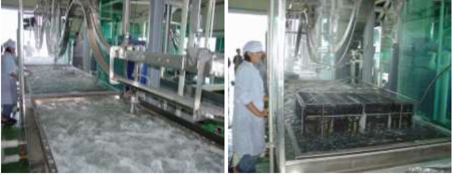
Resim 13. Ön Yıkama Sonrası İkinci Yıkama İşlemi
