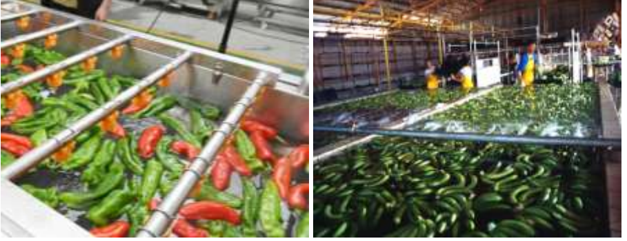
Resim 8. Yüzdürme Yıkama Yöntemi
