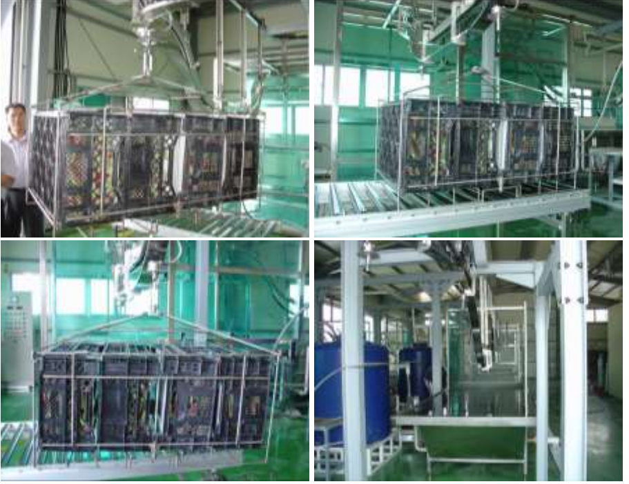
Resim 11. Kasaların Yıkama Ünitesine İletilmesi
