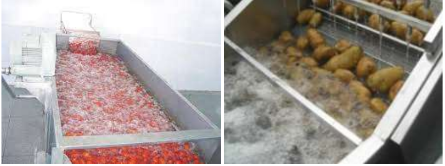
Resim 4. Durgun Su Kullanılan Yıkama Tankı ve Yıkama Havuzu
