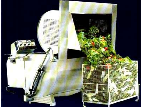
Resim 9. Yana Boşaltma Sistemli, Girdap Hareketli Su Akımı Sistemine Göre Çalışan Yıkama Makinası
