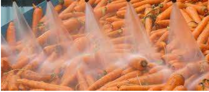
Resim 7. Yüksek Basıncılı Yıkama Uygulaması
