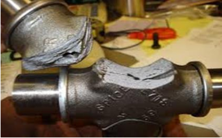
Şekil 07. Mafsal İstavrozu Kırılması
