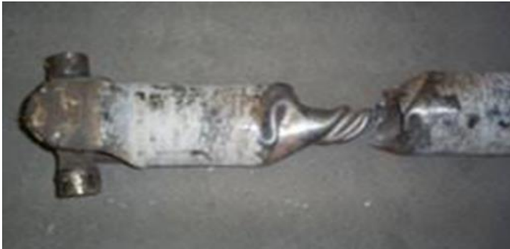
Şekil 22. Burulan Şaft Borusu
