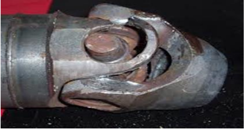
Şekil 16. Yağsızlık Sonucunda Mafsalın Dağılması
