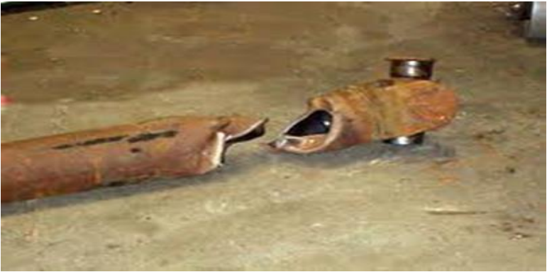
Şekil 20. Kopan Şaft Borusu
