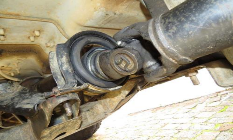
Şekil 18. Askı Bilyesinin Dağılması
