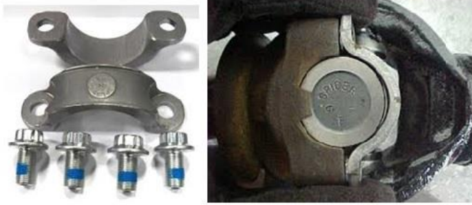
Şekil 11. Kep Bağlantılı İstavroz ve Kepler
