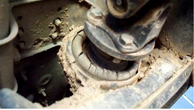
Şekil 19. Askı Lastiğinin Yırılması
