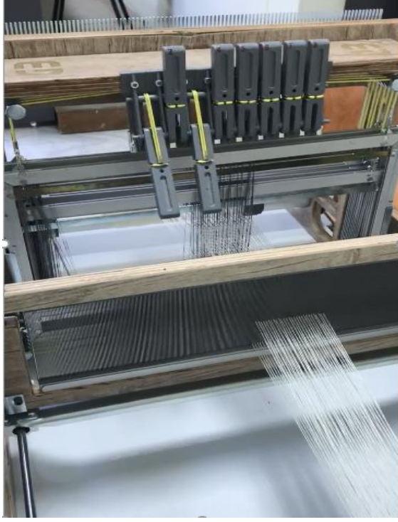
Şekil 3.4. Masa tezgahında çerçevelerin manuel olarak indirilip kaldırılmasını sağlayan mandallar
