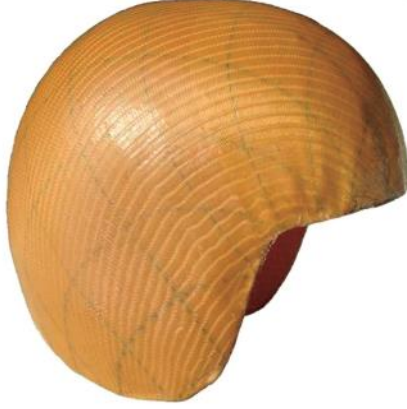
Şekil 6.14. Dokuma kumaşın kalıplanması ile üretilmiş kask (Roedel ve Chen, 2007)
