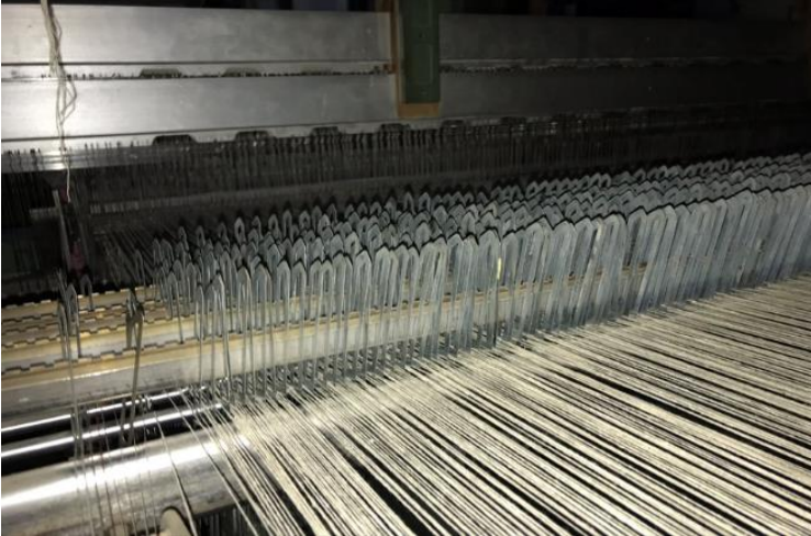
Şekil 3.12. Otomatik bir dokuma tezgahında çözü ipliklerinin üzerinde bulunan lameller
