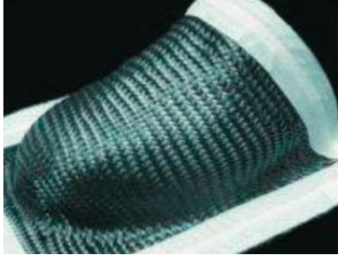
Şekil 6.12. Doğrudan dokuma ile üretilmiş 3D Shell kumaş örneği (Busgen, 1999)
