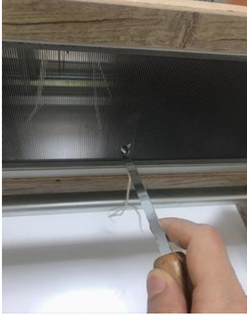
Şekil 2.9. Çözümlerin tarak tığı kullanılarak tarak dişleri arasından geçirilmesi
