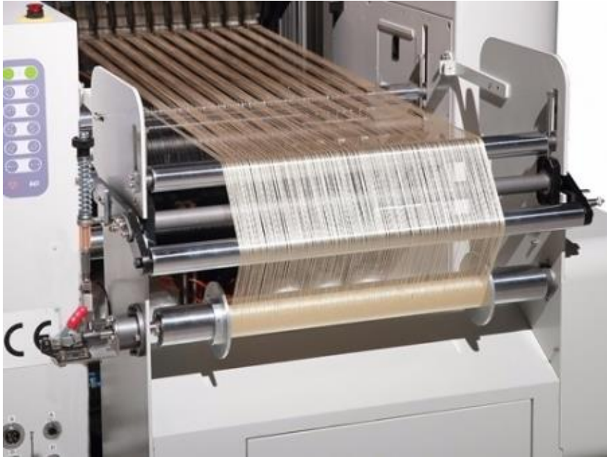
Şekil 3.11 Dijital gerilim kontrollü elektronik çözgü salma sistemi (CCI, 2022d)
