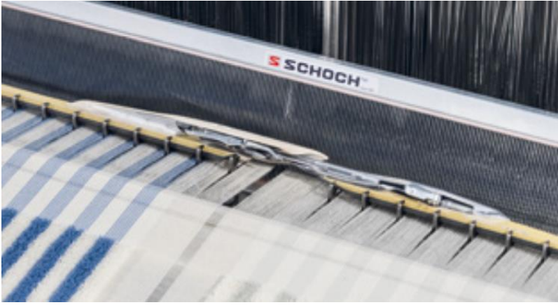
Şekil 3.8. Çift kancalı atkı atım sistemi (Itama, 2022b)
