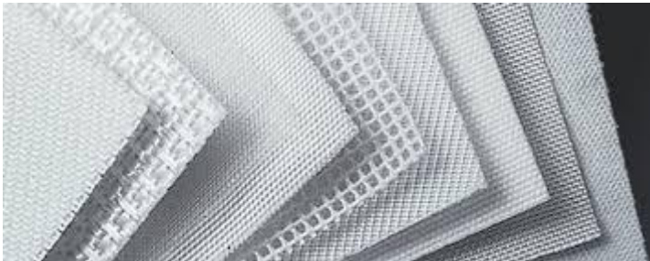
Şekil 7.3. Dokuma filtre yapıları (Testori, 2022)
