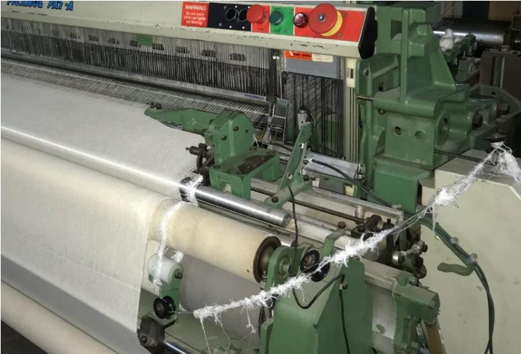
Şekil 3.9. Hava jetli atkı atım sistemine sahip dokuma tezgahı
