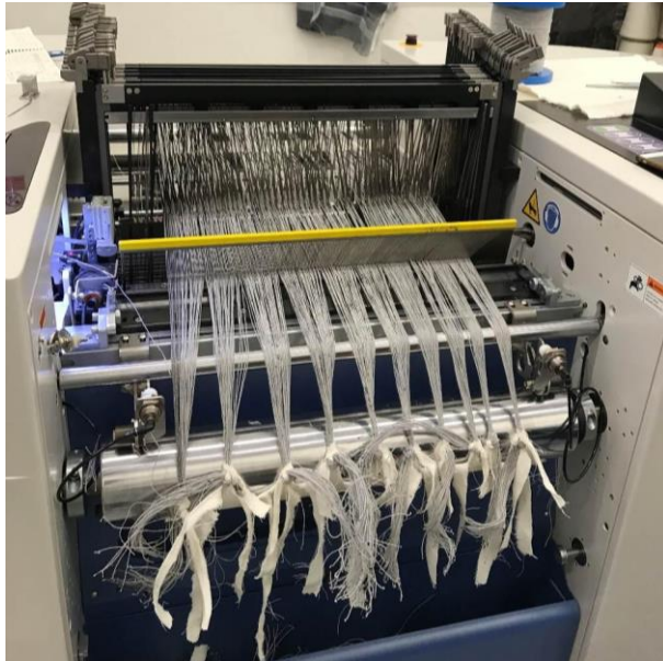
Şekil 2.10. Gücü ve tarak taharı tamamlanmış çözgü iplikleri
