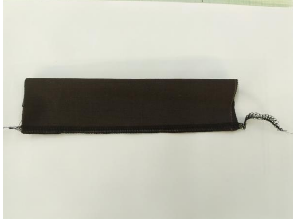
Şekil 125. Fileto katlama ve overlok işlemi
