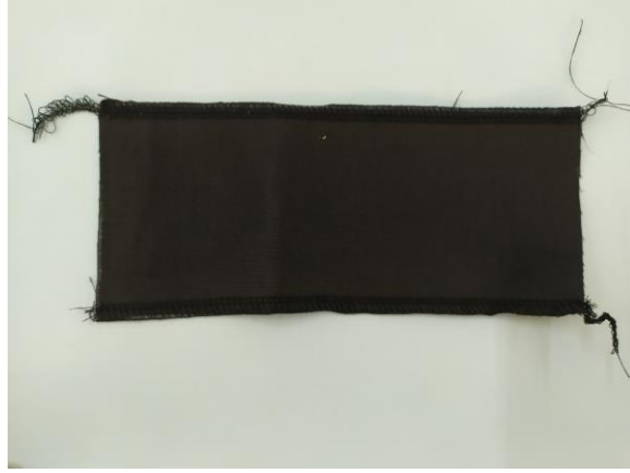
Şekil 126. Fileto karşılığı uzun kenarların overlok işlemi
