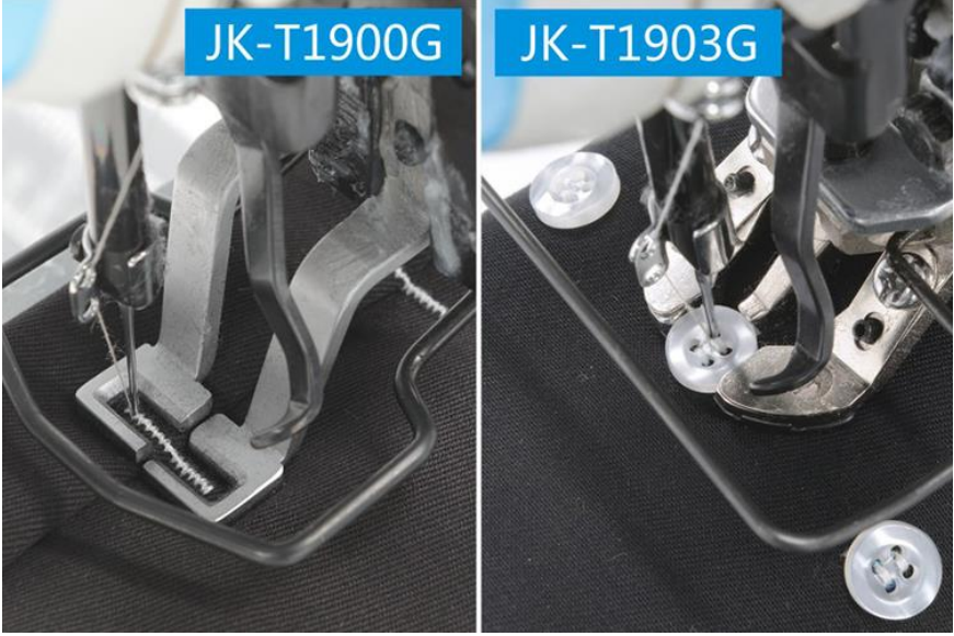
Şekil 66. Punteriz otomati ve düğme otomati ( https://www.jacksewingmachines.co.uk )
