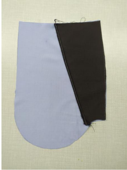
Şekil 119. Cep karşılıklarının cep torbalarına tutturulması
