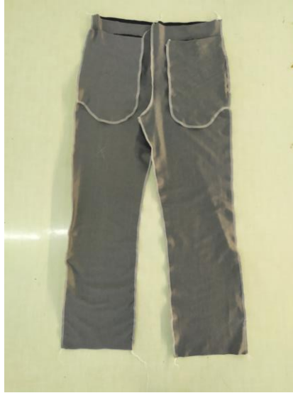
Şekil 153. Yan birleştirme ve iç paça dikişi
