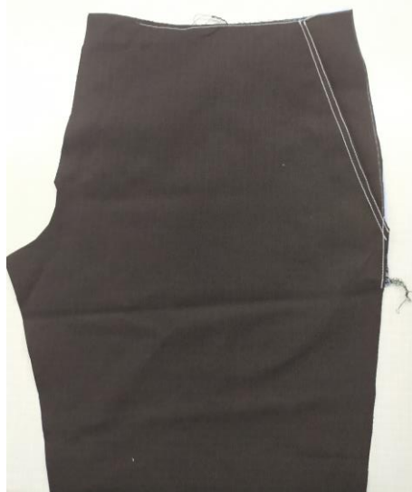
Şekil 123. Ön beden kemer ve yan dikiş hazırlık işlemi
