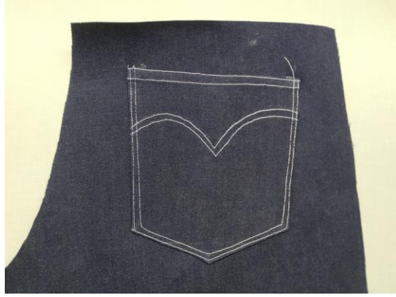
Şekil 83. Arka cep kenarı çima ve gaze dikişleri
