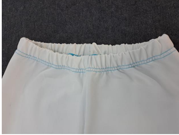
Şekil 162. Kemer kıvrırma (reçme dikişi)
