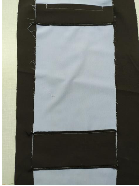
Şekil 131. Fileto parçasını çimayla tutturma
