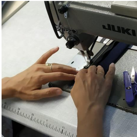
Şekil 92. Patlete fermuar tutturma
