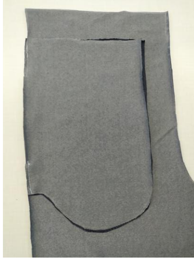
Şekil 149. Cep torbalarını hizalama ve cep ağız dışında kalan yan dikiş hattının birleştirilmesi
