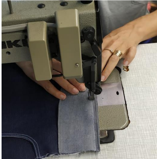
Şekil 95. Patlet karşılığının sol ön bedene tutturulması
