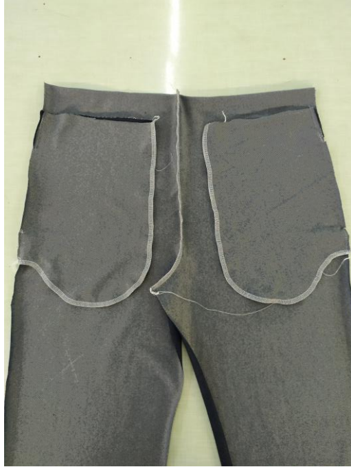
Şekil 151. Ön orta (ağ) overlokla birleştirme
