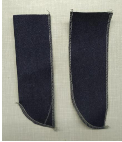
Şekil 91. Patlet ve patlet karşılığı overlok dikişleri
