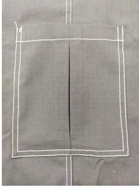
Şekil 141. Kargo cep montaj çima ve gaze dikişleri
