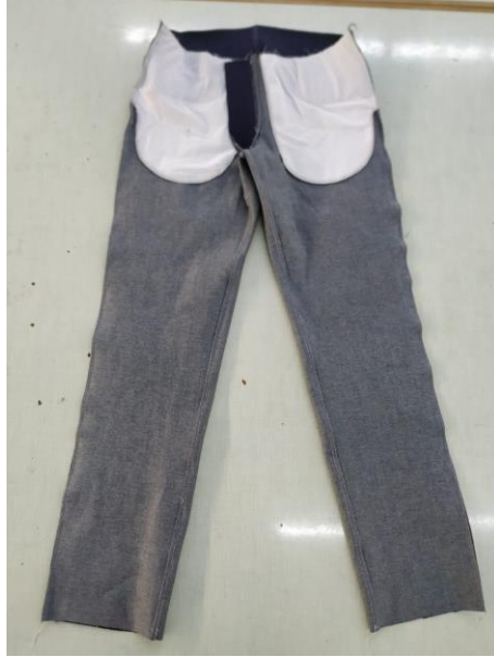
Şekil 104. Yan birleştirme dikişleri
