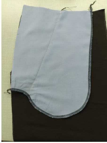
Şekil 122. Cep torbalarını birleştirme
