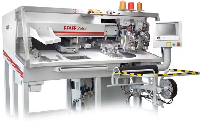
Şekil 62. Arka cep süs dikişi otomatik kalıpları ( https://www.teksmakmakina.com.tr )
