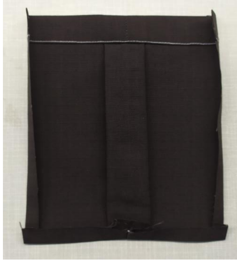
Şekil 140. Kargo cep kenar kıvrırma ara ütü işlemi
