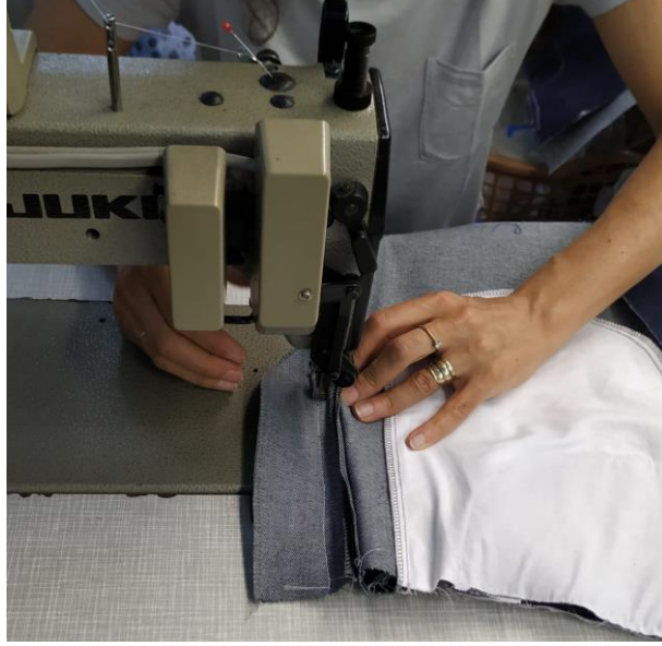
Şekil 97. Patlet karşılığına fermuarın tutturulması
