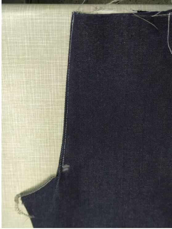
Şekil 96. Sol ön beden (patlet karşılığı) çima dikişi
