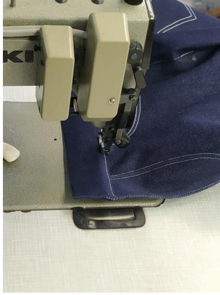
Şekil 109 . Kemer (tulumlama) ara ütü sonrası çima başlangıcı
