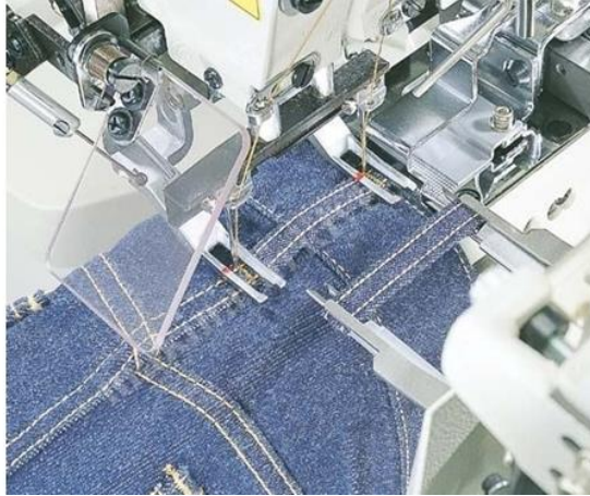
Şekil 111. Kemer köprü takma
