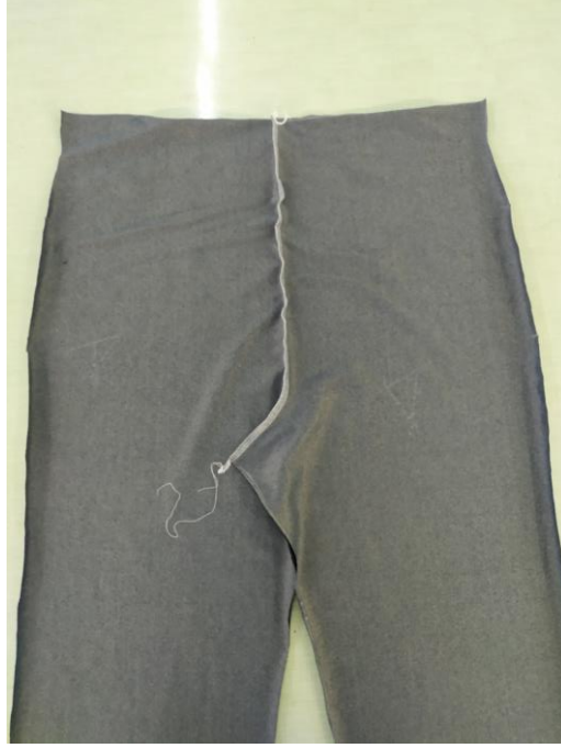
Şekil 152. Arka orta (ağ) overlokla birleştirme
