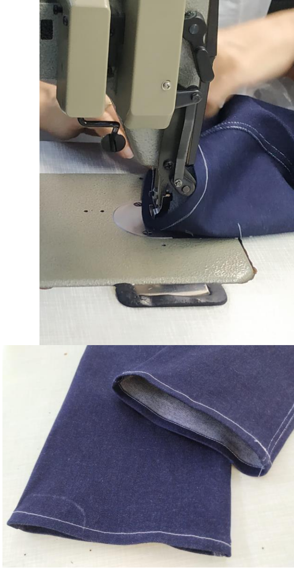
Şekil 113. Paça kıvrırma çırma dikiş
