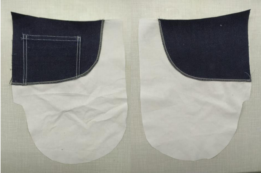
Şekil 74. Cep karşılıklarının cep torbalarına tutturulması
