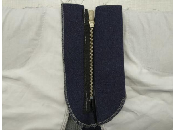
Şekil 98. Patlet karşılığına fermuarın tutturulması
