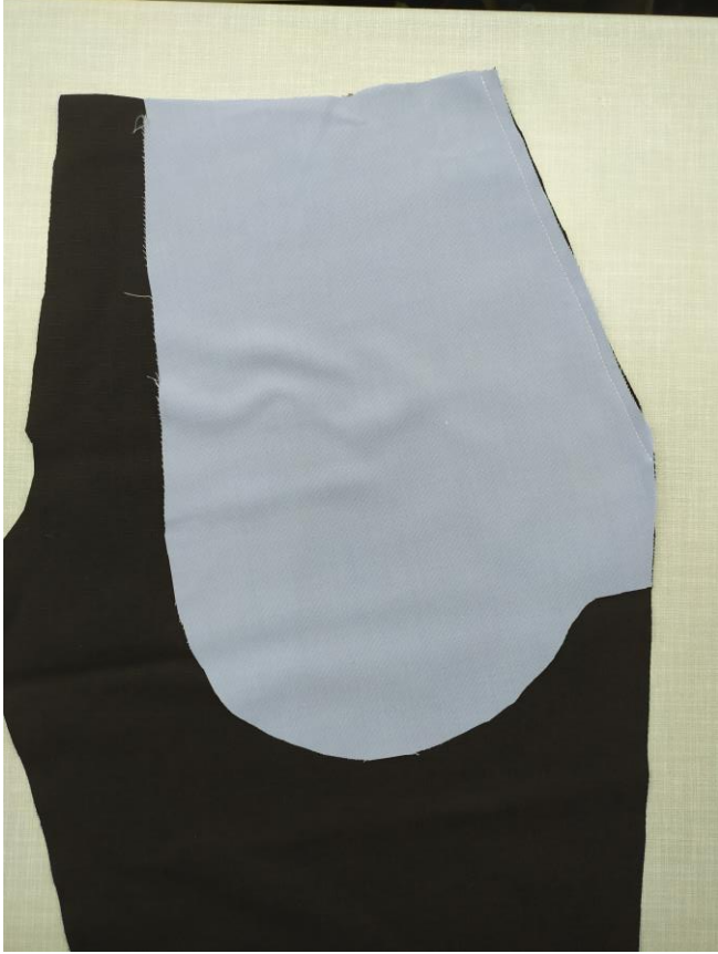
Şekil 120. Cep karşılıklarının cep torbalarına tutturulması
