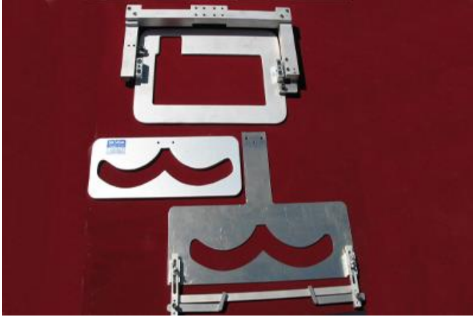
Şekil 62. Arka cep süs dikişi otomatik kalıpları ( https://www.teksmakmakina.com.tr )
