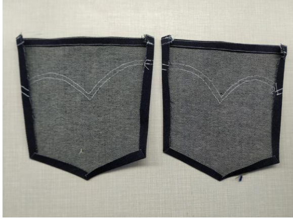
Şekil 82. Arka cep kenarı kıvrırma ara ütü işlemleri
