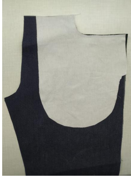
Şekil 75. Cep torbalarının ön bedenlere tutturulması
