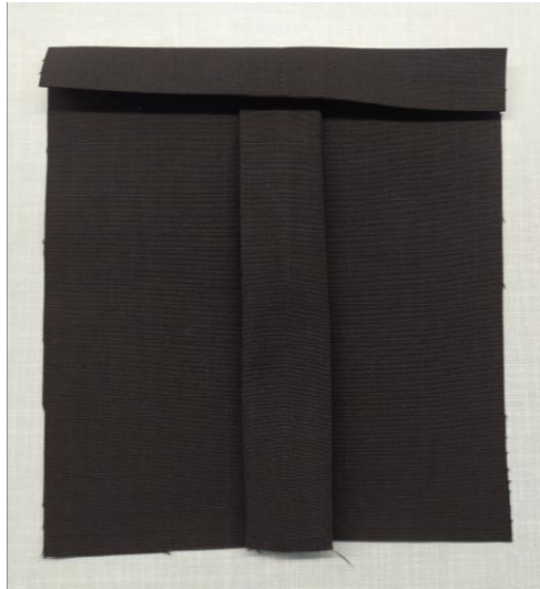
Şekil 138. Kargo cep ağzı temiz kıvrırma ara ütü işlemi
