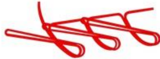
Şekil 45. 103 kodlu tek iplikli gizli zincir dikiş (Coats dikiş tipleri sınıflandırma kılavuzu)
