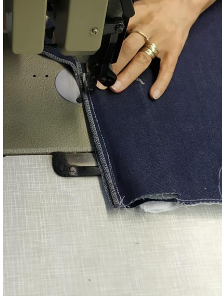
Şekil 93. Fermuarlı patletin sağ ön bedene tutturulması
