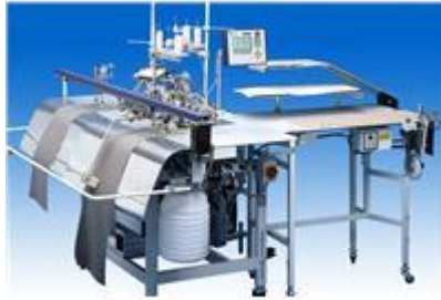
Şekil 59. Çift kafalı sürfile otomatı ( http://www.kecoglubiraderler.com )
