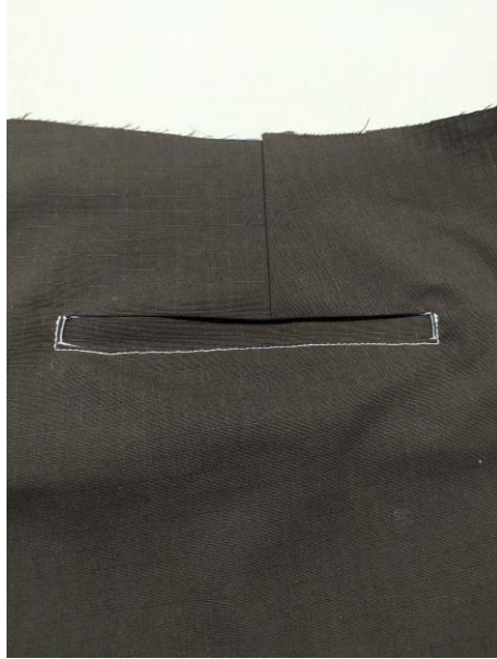
Şekil 130. Fileto parçasını çimayla tutturma
