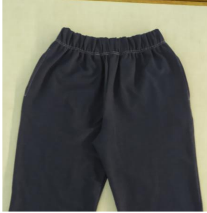
Şekil 155. Lastik payının kıvrılması
