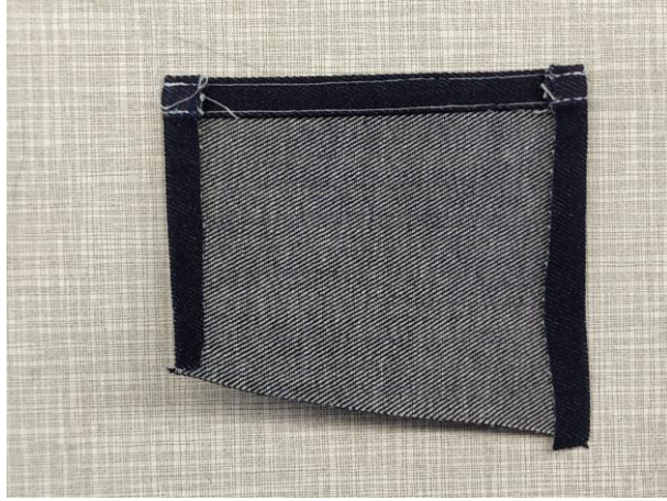
Şekil 71. Kibrit cep yan kıvrma ara ütü işlemleri
