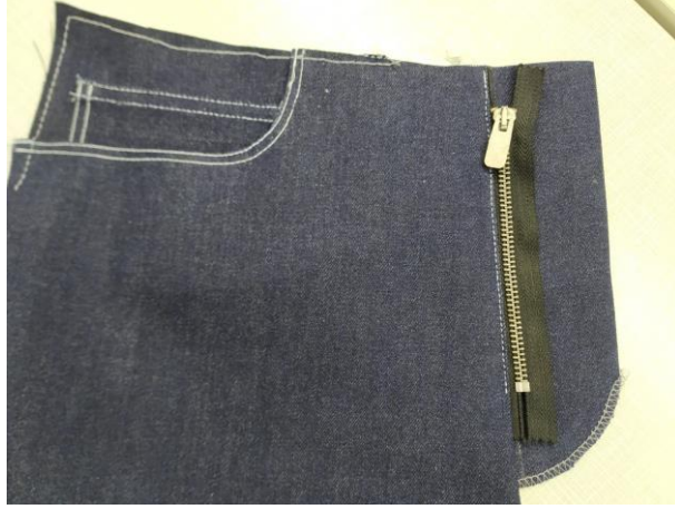
Şekil 94. Fermuar kenarı çima dikişi
