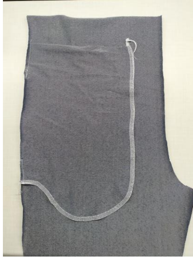
Şekil 150. Cep torbalarını overlokla birleştirme
