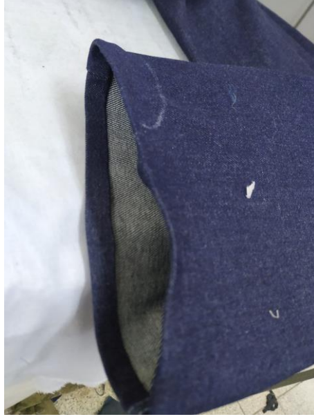
Şekil 112. Paça kıvrırma ara ütü işlemi
