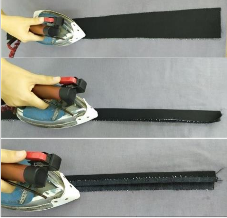
Şekil 106. Kemer hazırlama ara ütü işlemleri
