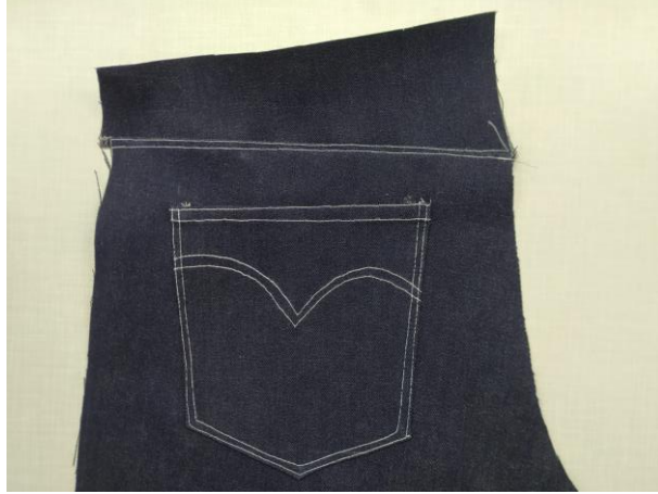
Şekil 87. Arka beden-conta çima ve gaze dikişleri
