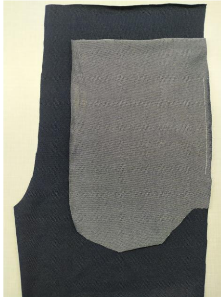
Şekil 147. Cep torbasının ön bedene tutturulması
