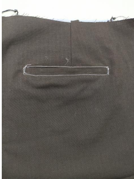
Şekil 133. Fileto parçasını çimayla tutturma
