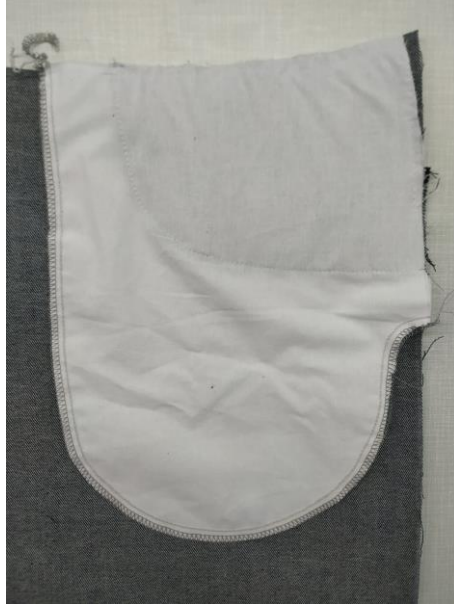
Şekil 77. Cep torbalarını birleştirme işlemi
