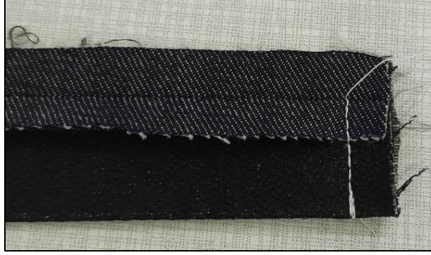
Şekil 107. Kemer hazırlama uç birleştirme
