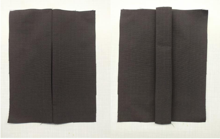
Şekil 137. Kargo cep pilikâşe ara ütü işlemi sonrası ön ve arka görünümü
