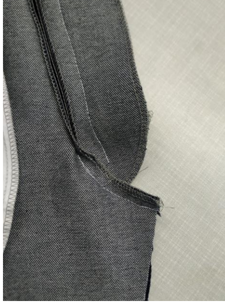
Şekil 99. Ön ağ birleştirme
