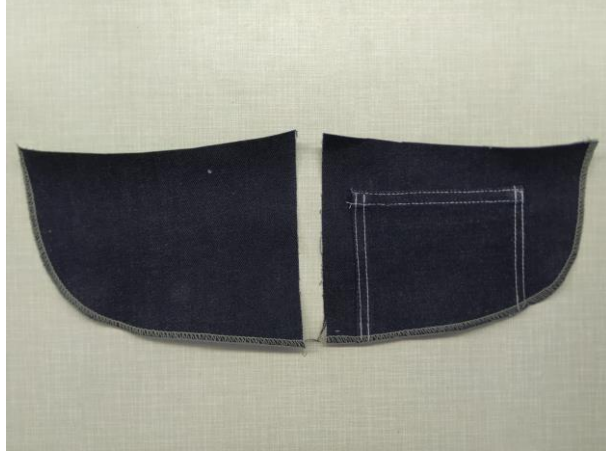
Şekil 73. Cep karşılıklarının alt kısmının overlokla temizlenmesi
