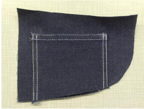
Şekil 72. Kibrit cep yan çima ve gaze dikişleri
