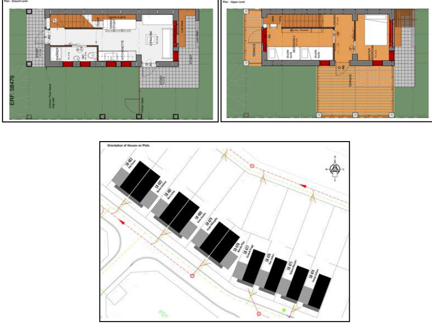
Şekil 15. 10x10 Sandbaghousing kat planları ve vaziyet planı (Dezeen, 2008)
