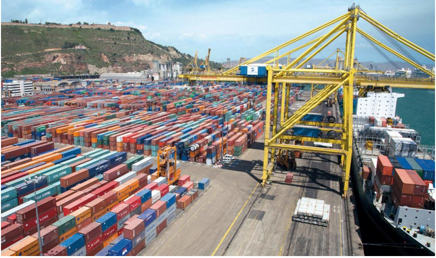
Şekil 3.25 Raylı Sistem Rıhtım Vinci (Ship to Shore Gantry Crane) 319
