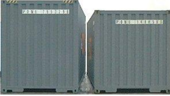
Şekil 3.21 Yüksek Hacimli (High-Cube) Konteyner (9' 6") ile Standart (8' 6") Konteyner Mukayesesi 289
