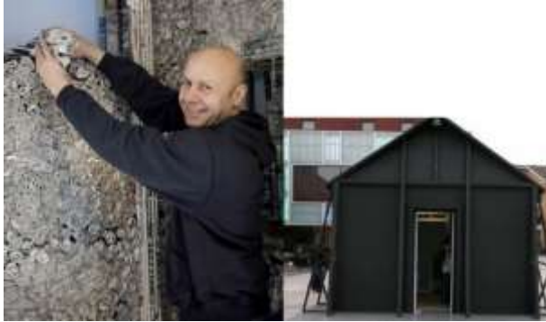
Şekil 84. Günlük Yaşamda Kullandığımız Kâğıdın Bina Yapımında Duvar Örgüsü Olarak Kullanımına Örnek (URL-106).
