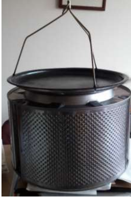
Şekil 121. Atık Çamaşır Makinesi Tamburu ve Çaycı Askısından Kolay Taşınabilir Bir Servis Sehpa'sı Tasarımı.
