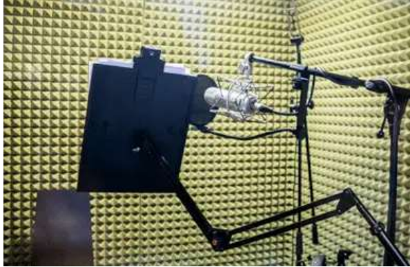
Şekil 127. Karton Yumurta Ambalajlarının Ses Kayıt Stüdyosunda Ses Yutucu Malzeme Olarak Kullanımı (URL-139).
