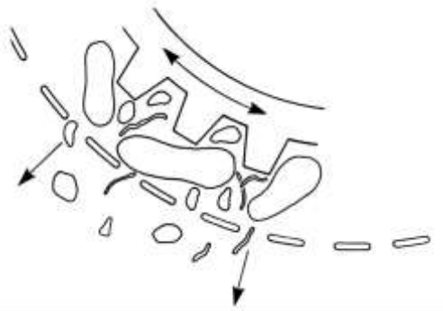
Şekil 3. 8. Salınımlı Yer Fıstığı Kabuk Kırma Makinasının Çalışma İlkesi (Pinson vd., 2014)
