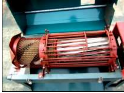
Şekil 6. 9. Kesme Etkili Kabuk Kavlatma Makinası (Sihno, 2023)
