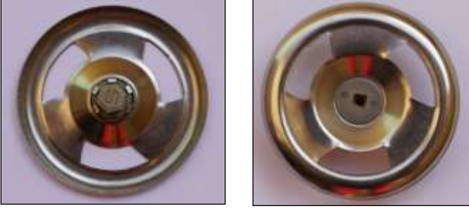
Şekil 2. 29. Tek Diskli Kabuk Kırma Makinasının Diskinin Üstten ve Alttan Görünüşü (Muttagi ve Joshi, 2017)
