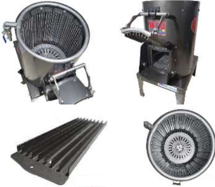
Şekil 6. 7. Testere Dişli Aşındırıcı Ceviz Kavlatma Makinası (Meltem, 2023)
