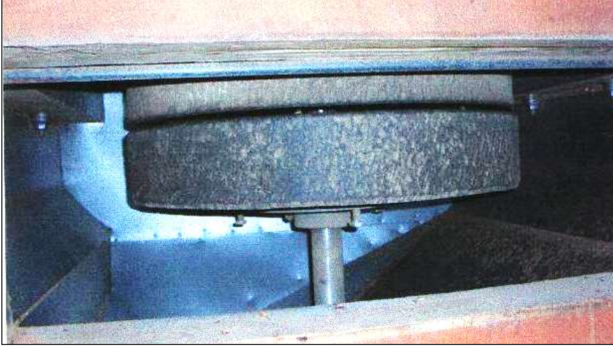
Şekil 4. 6. Taşlı ya da Diskli Kırıcının Taşları (Duran, 2006)
