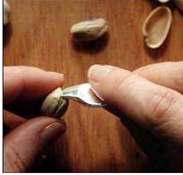
Şekil 5. 8. İçi Kabuktan Ayrırmada Kullanılan Basit Bir El Aleti (Pistachio Nut Opener, 2023)
