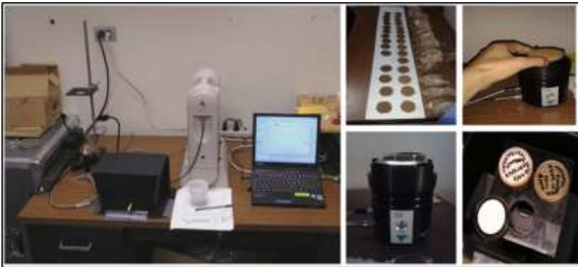
Şekil 5. Spektrometre ile laboratuvar ortamında toprak yansımalarının elde edilmesi
