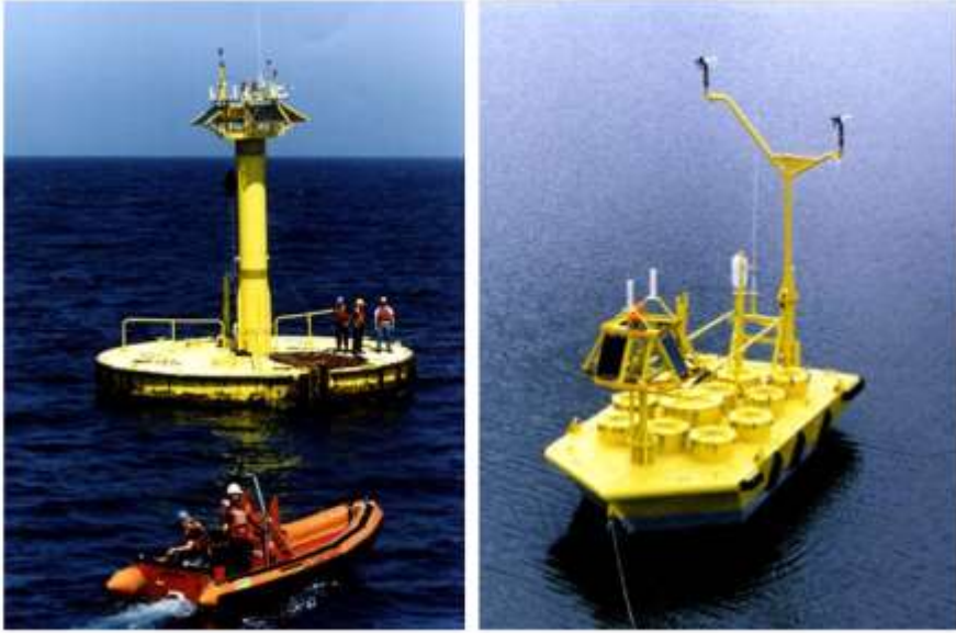
Şekil 3. National Oceanic and Atmospheric Administration (NOAA) Göre Sabit Şamandıra Örnekleri ( http://www.ndbc.noaa.gov/ ).
