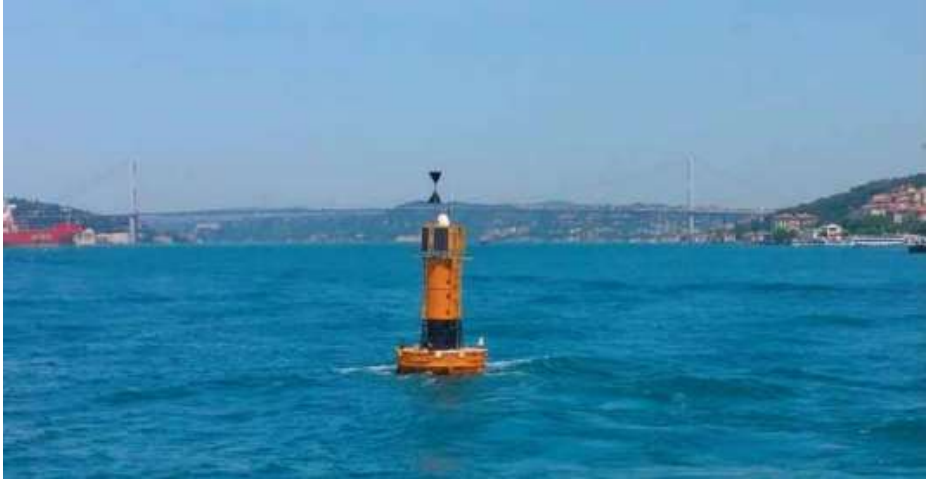
Şekil 1. Sabit IALA Şamandırası Örneği ( https://www.martek.com.tr/ )
