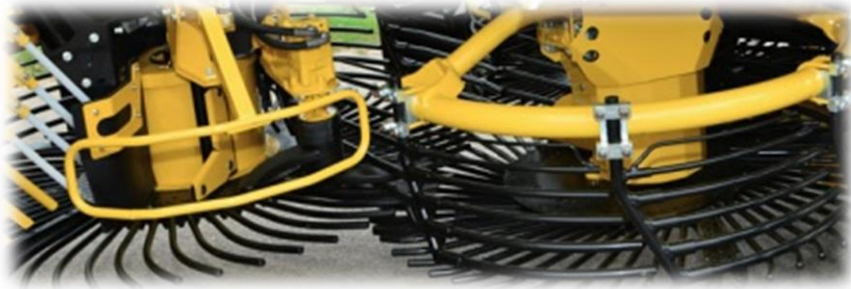
Şekil 5. Temizleme sistemi (Tuğrul, 2022)
