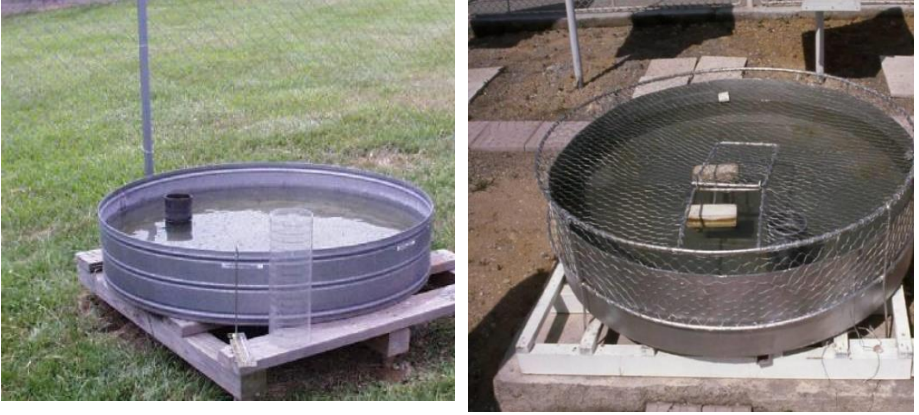
Şekil 2. A sınıfı buharlaşma kabı örnekleri, (DMİ; son erişim tarihi:18.07.2023)
