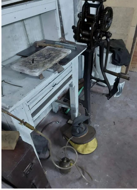
Fotoğraf 32. Kuyumcu Tezgâhı, Şalimo (Şalome), Pürmüz (körüük), Silindir Makinası, Amyant Levha.
