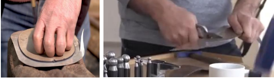
Fotoğraf 104. Kalıpların Çıkarılması ve Kesilmesi.
