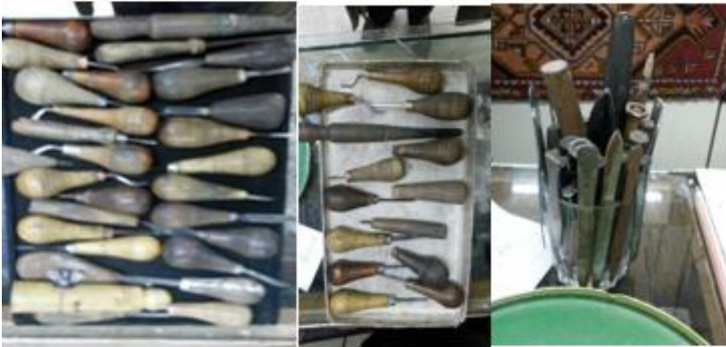
Fotoğraf 22. Gümüş İşlemede Kullanılan Kalemler.
