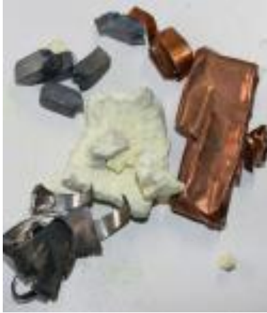
Fotoğraf 33. Savat Hazırlanırken kullanılan malzemeler (Er, 2012: 63).
