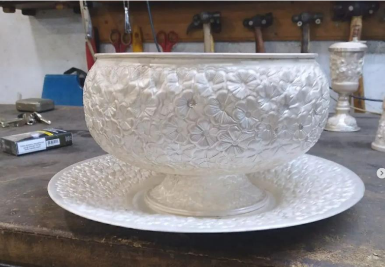
Fotoğraf 102. Kabartma Tekniğı ile Hazırlanan Şekerlik ve Altığı (Dönmez Atölyesi).
