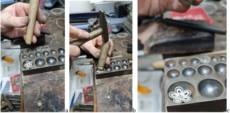
Fotoğraf 74a.b.c. Parçanın Şekillendirilmesi, Bombe Demiri, Zar Heşdek.
