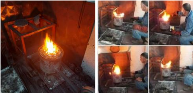
Fotoğraf 16. Gümüşün Eritilmesi.
