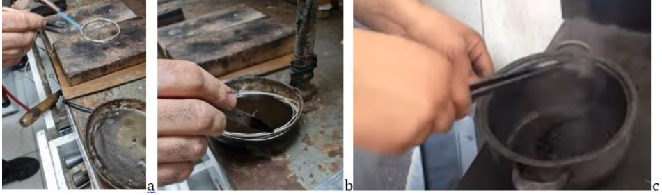
Fotoğraf 58a.b.c Tavlama ve Soğutma İşlemi.
