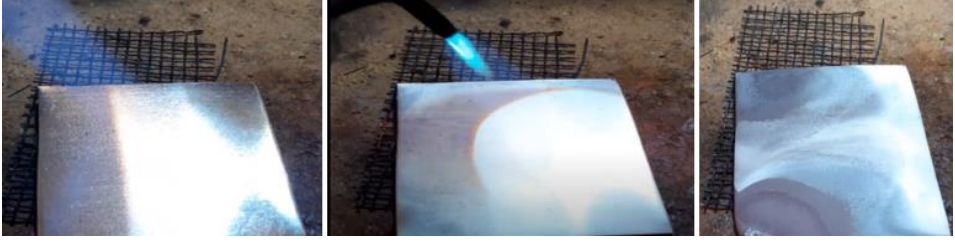
Fotoğraf 106. Tavlama İşlemi Sırasında Oluşan Renkler.
