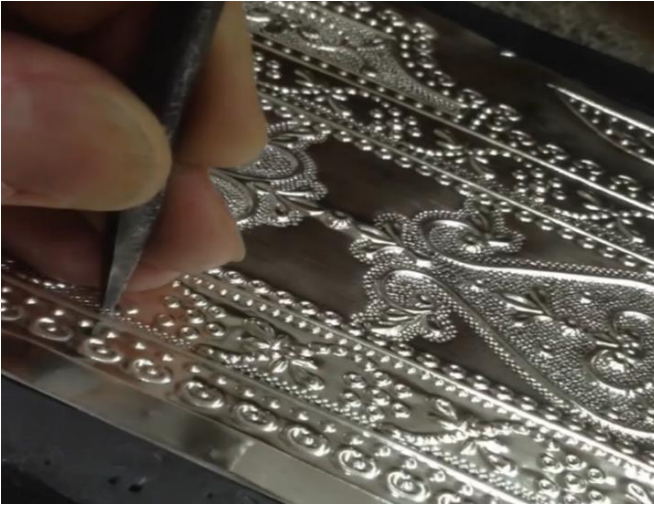
Fotoğraf 111. Kum Kalemi ile Boşlukları Doldurulması.
