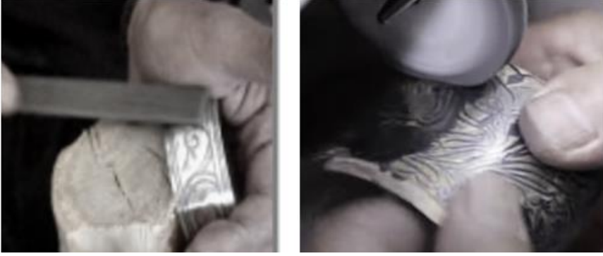
Fotoğraf 29a. Eğre ve Polisaj ile Tesviye İşlemi.
