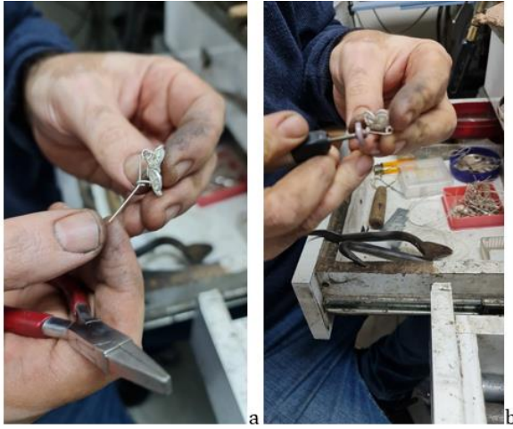
Fotoğraf 79a.b. İğne Eklenmesi.
