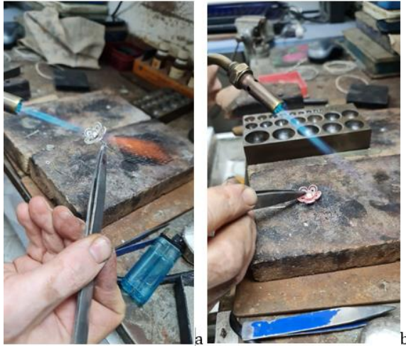
Fotoğraf 76a.b. Parçaların Tutturulması.
