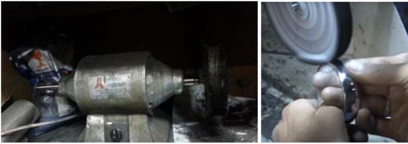
Fotoğraf 29b. Polisaj Motoru ve Parlatma İşlemi.
