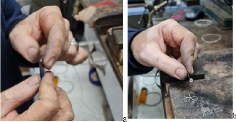
Fotoğraf 71a.b. İç Dolgunun Hazırlanması, Vav Dolgu.
