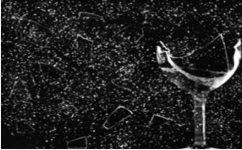
Şekil 4: Bu cam kadeh, cam kadehin rezonans frekansıyla aynı frekansta olan yüksek şiddetli bir ses dalgası tarafından parçalanmıştır. Ses gözle görülmezken, sesin etkileri varlığını kanıtlamaktadır ( https://openstax.org/books/university-physics-volume-1/pages/17-1-sound-waves ).
