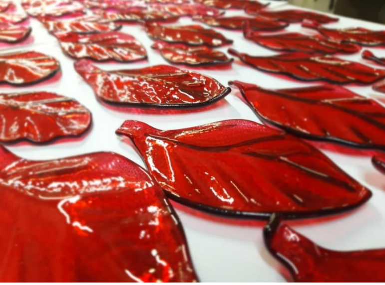
Resim 6; Şekillendirilen camların boyanması sonrasında uygun derecede ve zaman aralığında fırınlanması. Fotoğraf, Kamuran Karaağaç arşivi.
