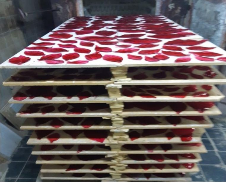
Resim 5; Şekillendirilen camların boyanması sonrasında uygun derecede ve zaman aralığında fırınlanması. Fotoğraf, Kamuran Karaağaç arşivi.
