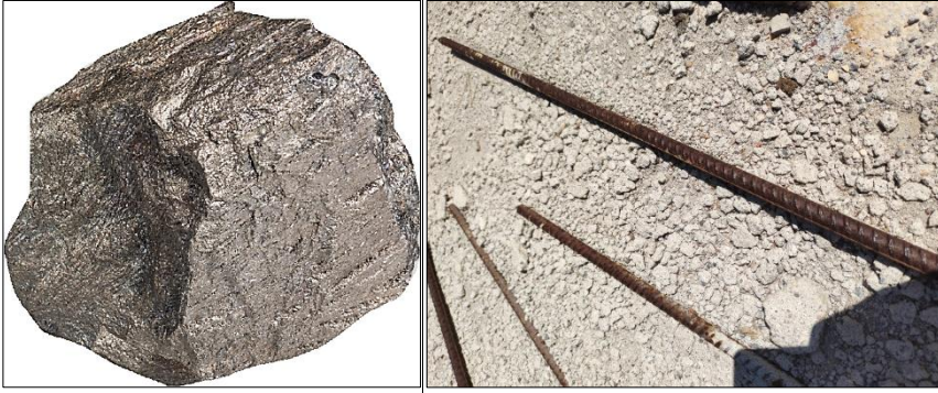
Şekil 1: Demir cevheri (solda) ve nervürlü inşaat demiri (sağda)
