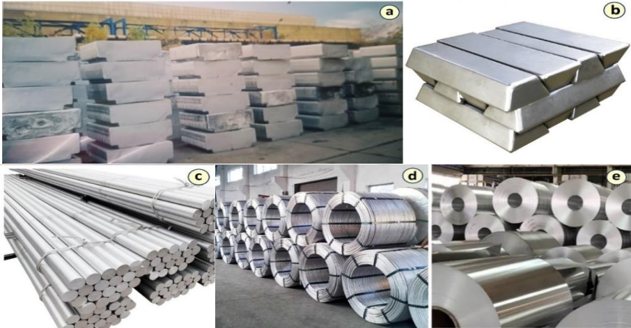
Şekil 11: a) Alüminyum üretim tesisi (Seydişehir-Konya) alüminyum bloklar, b) Alüminyum külçeler, c) Alüminyum kütükler (bilet) d) Alüminyum filmaşın e) Alüminyum folyo (www.alibaba.com)
