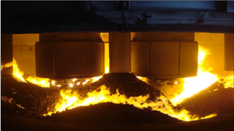
Şekil 8: Elektrik ark fırını ve ferrokrom üretimi (Çınar, 2018)
