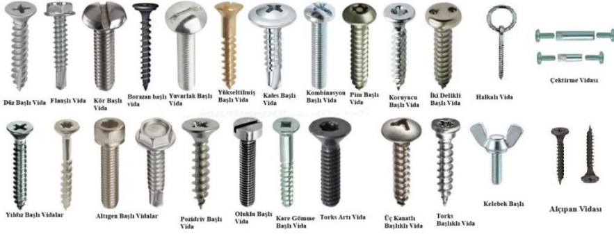
Şekil 57. Başlarına Göre Bazı Vida Çeşitleri (Types of Screw and Bolt and Their Uses, 2023). 23
