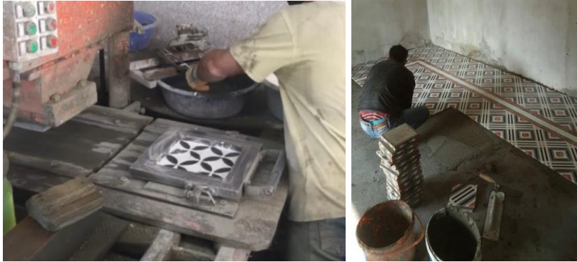
Şekil 34. Doğrudan Uygulama Yöntemiyle Üretilen Karo Mozaik (Karo Siman 16 ) (Şahin, 2019) ve Uygulanması (Sistiresiz Desenli Karolar, t.y.).
