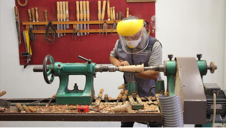
Şekil 91. Torna Tezgâhında Ahşaba Biçim Verme (Kara, 2019).
