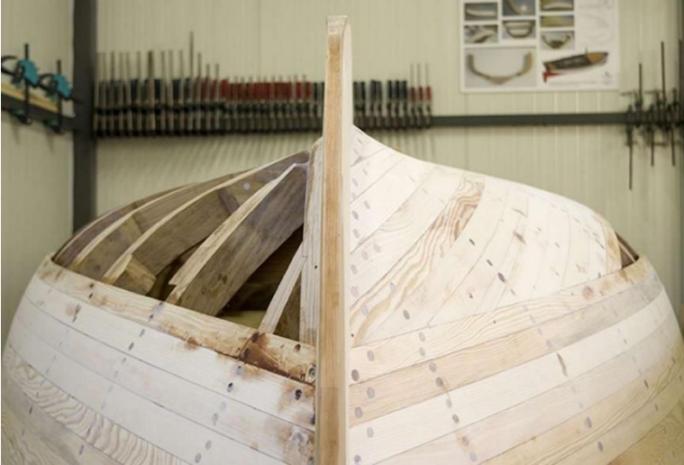
Şekil 140. Kuşaklı Eğri Yüzey Oluşumu ile İnşa Edilen Bir Masif Ahşap Sandal (Plaforma Wooden Boat Workshop, 2020).
