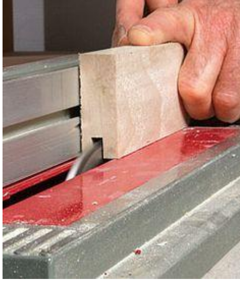
Şekil 106. Değişik Geçme Çözümleri ve Geçme Yuvasının Açılması (Demirarslan, 2005; Alexander, t.y.).
