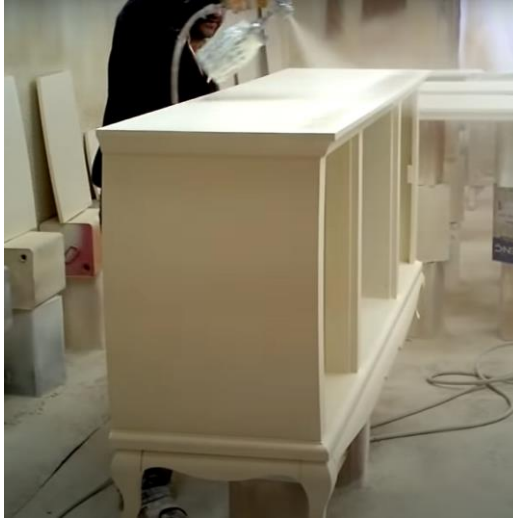
Şekil 90. CNC Makinası ile Oyma (Luxurious Wooden Door Design by CNC Router Machine, t.y.) ve Lake Boya ile Ahşap Yüzeyin Boyanması (Lake Boya, Lake Mobilya Boyama, Lake Cila, Lake Mobilya Cilas, 2014).
