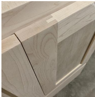
Şekil 149. Çatallı Geçme Çerçeve Konstrüksiyon Bir Dolap Kapağının Üstten Görünüşü (Popular Woodworking Step By Step Projects Pdf Free Download | Waste To A Cool Woodworking Project, t.y.).
