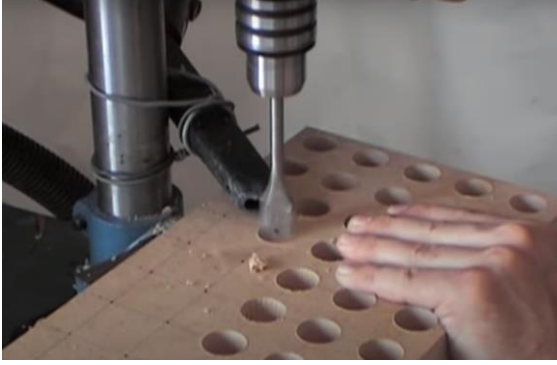
Şekil 88. Ahşap Malzemede Delik Delme (Palmella Portabossoli, 2010).
