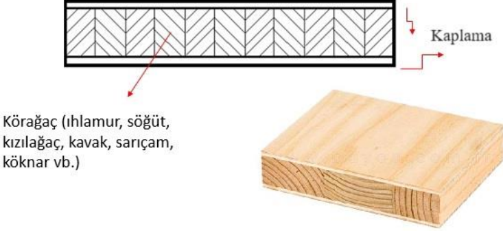
Şekil 79. Kontratablayı Oluřturan Katmanlar.
