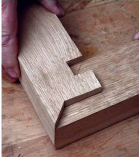
Şekil 156. Seren ve Başlık Birleşmesinde Farklı Bir Yöntem Uygulaması (Article Series on Japanese Joinery, 2015)
