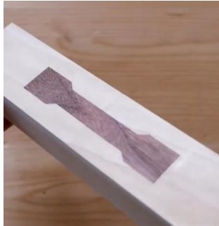
Şekil 111. Kavelanın Görünür Şekilde Uygulandığı Bir Örnek (Science Set Free, 2023).
