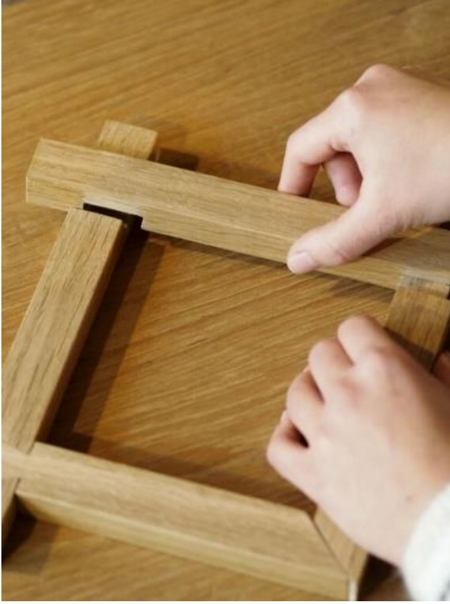
Şekil 147. Seren ve Başlıkta Kertme Yuvası Açılarak Birleştirme (Seren ve Başlıkta Kertme Yuvası Açılarak Birleştirme, 2023).
