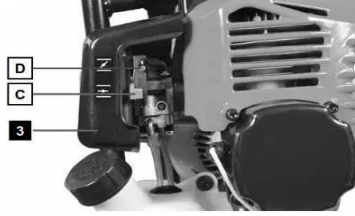
Şekil 62. Rölantinin ayarlanması Kaynak: Anonim, 2021a
