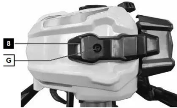
Şekil 65. Buji kapağının sökülmesi Kaynak: Anonim, 2021a
