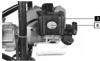
Şekil 63. Hava filtre kapağının sökümü Kaynak: Anonim, 2021a
