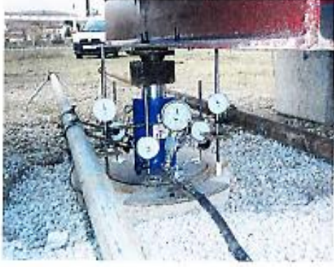
Şekil 7.5 Taş Kolon Yükleme Düzeneği (Kurt, 2011)
