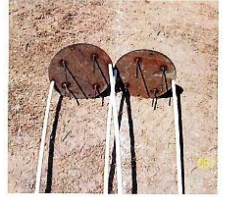
Şekil 7.5 Taş Kolon Yükleme Düzeneği (Kurt, 2011)
