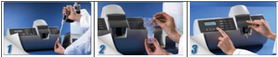
Şekil 7. Coulter sayacı cihazında örnek hazırlama (1), ölçüm (2) ve analiz (3) aşamaları (Anonim, 2023c)
