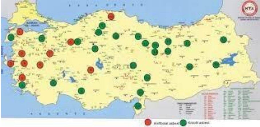
Şekil 3: Türkiye’ de Asbest Bulunan Şehirler (Yeşil Renk, Krizotil Asbest; Kırmızı Renk, Amfibol Asbest Bulunan Şehirleri Göstermektedir) (Atabey, 2015).
