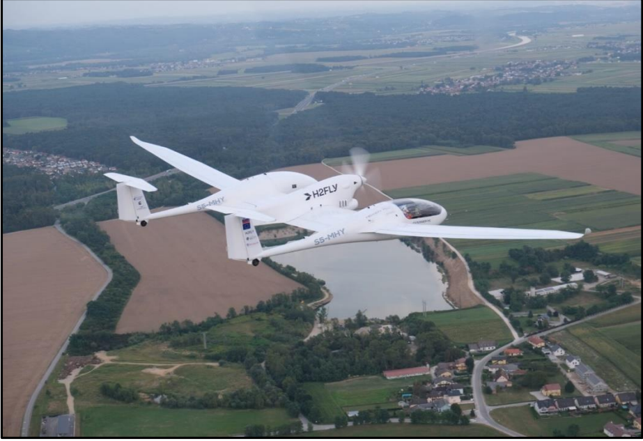
Şekil 15: Dünyanın ilk sıvı hidrojenle çalışan gösteri uçağı HY4
