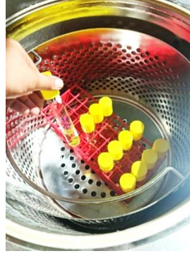
Şekil 4. EC metre ile EC 1 değeri tayini Şekil 5. EC 2 ölçümü için otoklav işlemi
