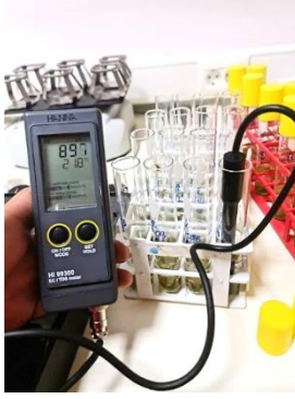
Şekil 4. EC metre ile EC 1 değeri tayini Şekil 5. EC 2 ölçümü için otoklav işlemi
