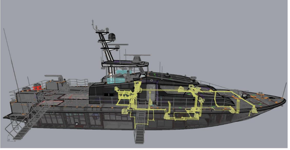
Şekil 7. HVAC Sistemi kanal planı
