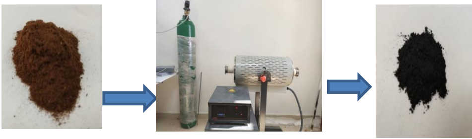
Şekil 2. Aktif karbon üretim sistemi
