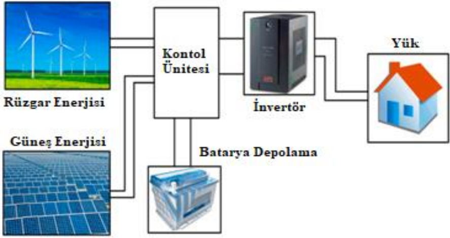
Şekil 6: PV-Rüzgar hibrit sisteminin diyagramı (Mahesh ve Sandhu.2015)
