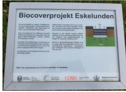
Şekil 17: Alanda bulunan Biocover projesi bilgilendirme panosu. \text{Çöp} \Rightarrow \text{CH}_4 \Rightarrow \text{Gaz dağıtım katmanı} \Rightarrow \text{CH}_4 + 2\text{O}_2 \rightarrow \text{CO}_2 + 2\text{H}_2\text{O} \Rightarrow \text{Metan oksidasyon tabakası} \Rightarrow \text{CO}_2 (Canatanoğlu, 2023).
