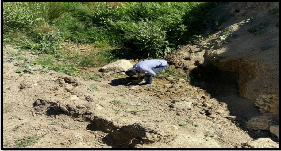
Fotoğraf 199. Sahanın Anakayasında Sızan Suyun TDS Ölçümü
