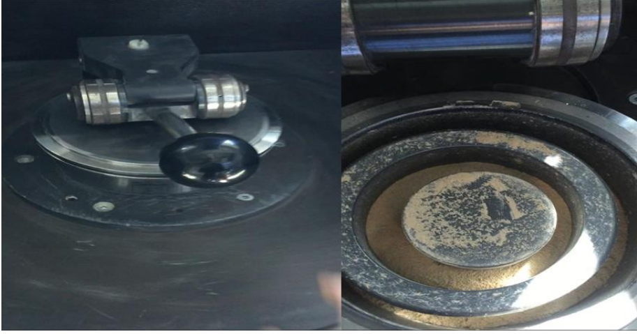
Fotoğraf 6. TitreŐimli Diskli Öğ¼t¼c¼ ile Y¼ksek AlaŐımlı Kap i¼erisindeki Kaya¼ Numunesinin TozlaŐtırma iŐlemi
