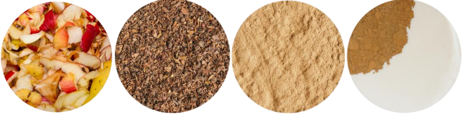
Şekil 37: Elma Posasının Kurutulması, İşlenmesi ve PU İle Karıştırılması (URL37)
