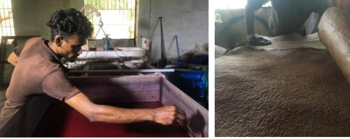
Şekil 52: Levha Oluşumu ve Hindistan Cevizi Derisi (URL44)
