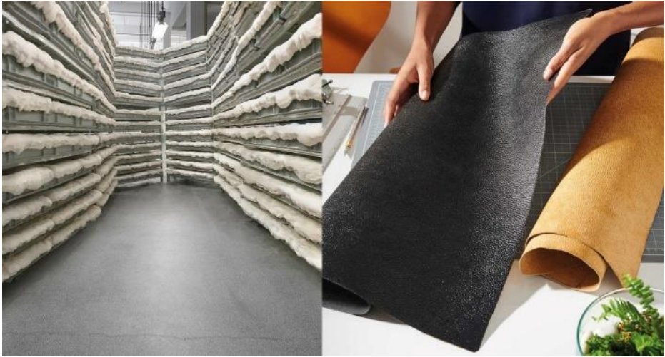
Şekil 12: Miselyum Köpük Matlar (solda) ve Bitmiş Mylo (sağda) (Bolt Threads) (URL21)
