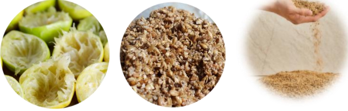
Şekil 47: Limon Posasının Kurutulması, İşlenmesi ve PU İle Karıştırılması (URL43)
