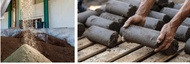
Şekil 22: Zeytin Atıklarının İşlenmesi (URL29)
