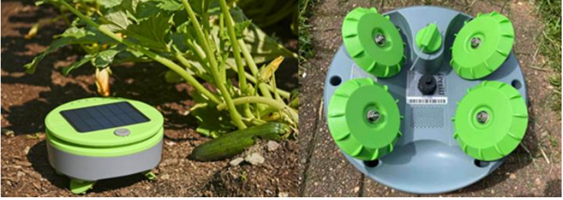
Şekil 4: Tertill: Kompakt Yabancı Ot Tespit ve Kesme Robotu (URL-4)
