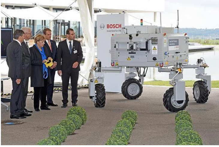
Şekil 2: S.W. Bonirob: Yabancı Ot Tespit ve Mekanik Temizleme Robotu (URL-2)
