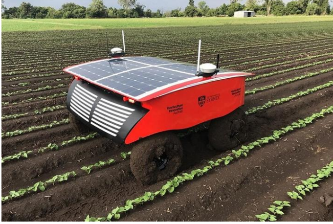
Şekil 6: RIPPA: Yabancı Ot Üzerine Herbisit Uygulaması Yapan Robot (URL-6)
