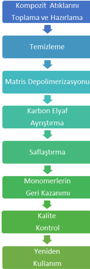
Şekil 4. Karbon Elyaf Takviyeli Kompozit Atıklarının Kimyasal Geri Dönüştürülmesi Süreçlerinde Uygulanan Temel İşlem Basamakları
