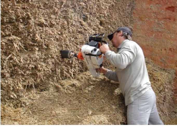
Şekil 4: Yoğunluk Ölçümünde Silindir Ve Motorlu Testere Kullanımı (De Carvalho ve Moro, 2017)
