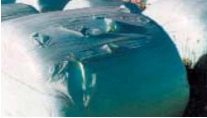
Şekil 4: Plastik, güneş ışığına uzun süre maruz kaldıktan sonra deformasyona uğrayacaktır (Fotoğraf: F. Mickan) (Mickan ve ark., 2003)
