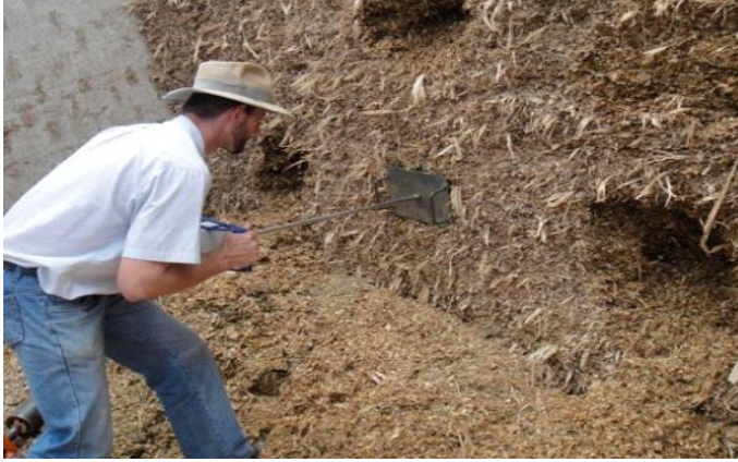
Şekil 3: Yoğunluk Ölçümünde Penetrometre Kullanımı (De Carvalho ve Moro, 2017)
