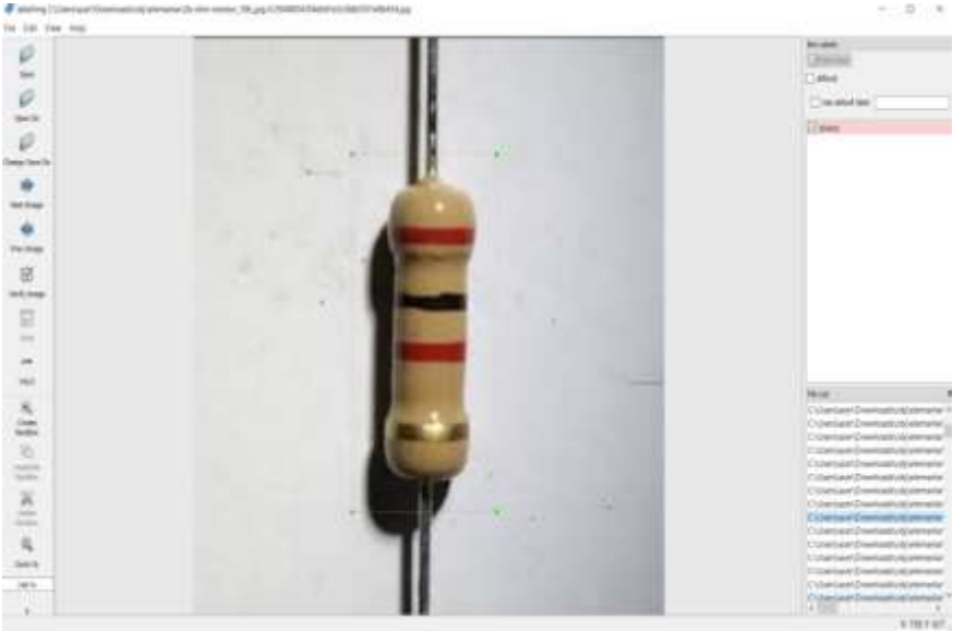
LabelImg Programı ile Etiketlenen Örnek Bir Direnç Görüntüsü
