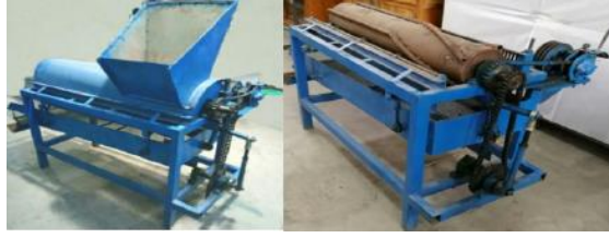
Şekil 5. 23. Sarmal Pervazlı Batörlü ve Izgara Kontrbatörlü Eksenel Akışlı Ayçiçeği Harman Makinası (Zhongyue ve Wenming, 2021)
