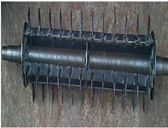
Şekil 5. 4. Tarak Dişli Pervazlı Açık Batör ve Tarak Dişli Pervazlar (Kazi vd., 2016)
