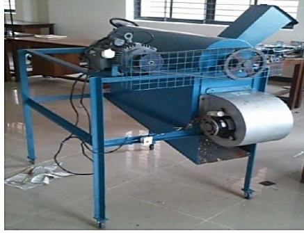
Şekil 5. 3. Tarak Dişli Pervazlı Açık Batörlü Eksenel Akışlı Ayçiçeği Harman Makinası (Kazi vd., 2016)
