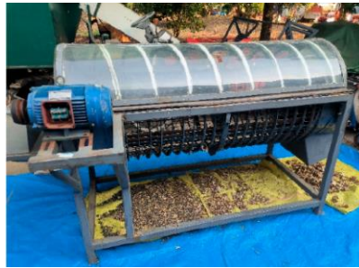
Şekil 5. 14. Pervazlı Batörlü ve Gravürlü Tamburlu Aksenal Akışlı Ayçiçeği Harman Makinası (Liu vd., 2023)
