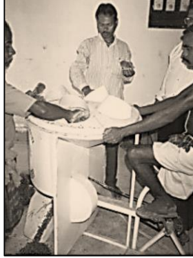
Şekil 3. 2. Harmanlama Tekerlekli Pedallı Ayçiçeği Harman Makinasıyla Çalışma (Goel vd., 2009)
