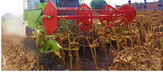
Şekil 7. 6. Tabla Helezonlu, Parmaklı Ayçiçeği Hasat Başlığıyla Tarlada Çalışma (Ochildiev vd., 2021)
