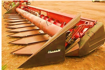
Şekil 7. 7. Tamburlu, Tabla Helezonlu ve Geniş Parmaklı Ayçiçeği Hasat Başlığı (Bigiron, 2024)
