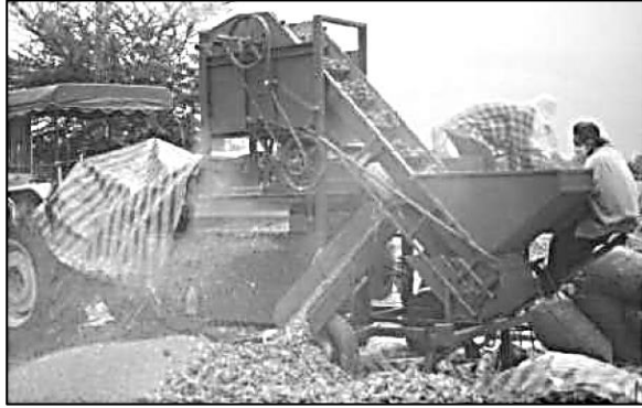
Şekil 5. 7. Pervazlı Batörlü ve Elips Şeklinde Delikleri Bulunan Tamburlu Aksenal Akışlı Ayçiçeği Harman Makinasıyla Çalışma (Sudajan vd., 2003)
