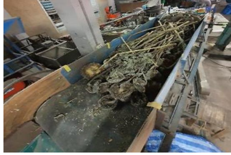
Şekil 5.12. Besleme Konveyörüyle Ayçiçeği Tablalarının Batör-Kontrbatöre Beslenmesi (Muenkaew vd., 2022)
