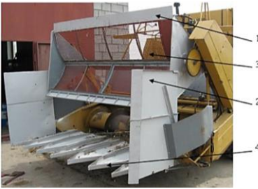
1. Dolap pervazı, 2. Yan kenar muhafazası, 3. Delikli sac, 4. Kutu tipi ayırıcı parmaklar.
