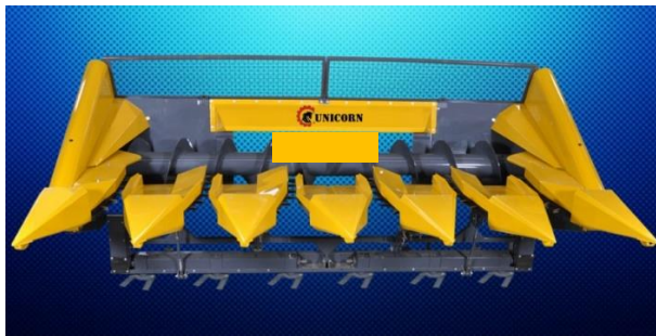
Şekil 7. 13. Sap Parçalama Düzenli Ayçiçeği Hasat Başlığı (Unicorn, 2024)
