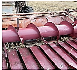
Şekil 7. 9. Helezonvari Dolaplı Ayçiçeği Hasat Başlığının Ayrıntılı Görünümü (Startsev vd., 2022)
