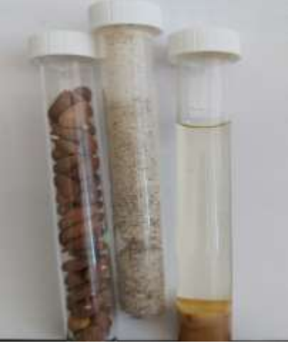
Resim 3. Bütün halde Acıpayam içi (solda), soğuk pres yağ alım makinesinden elde edilen acıpayam küspesi (ortada) ve soğuk pres acıpayam ham yağı (sağda)
