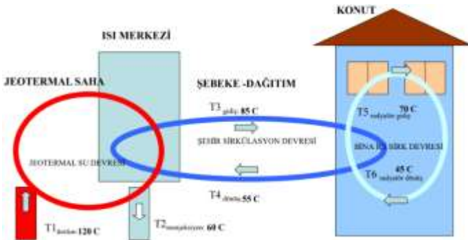
Şekil 6: Bölge Isıtma Sistemi Akım Şeması
