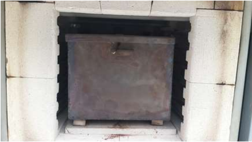
Şekil 3: Biyokömür üretimi için özel imal edilmiş kabın kül fırını içerisindeki görüntüsü
