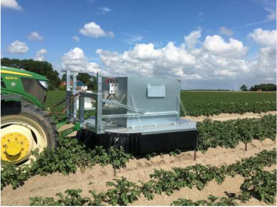
Şekil 17: Hiperspektral görüntüleme sisteminin tarla koşullarında kullanılması için tasarlanan kabinin görünümü (Polder vd., 2019)
