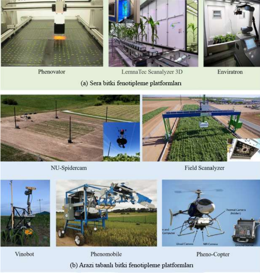
Şekil 1: Farklı amaçlara göre tasarlanmış ticari fenotipleme platformları: (a) Sera bitki fenotipleme platformları, (b) Arazi tabanlı bitki fenotipleme platformları (Li vd., 2020)
