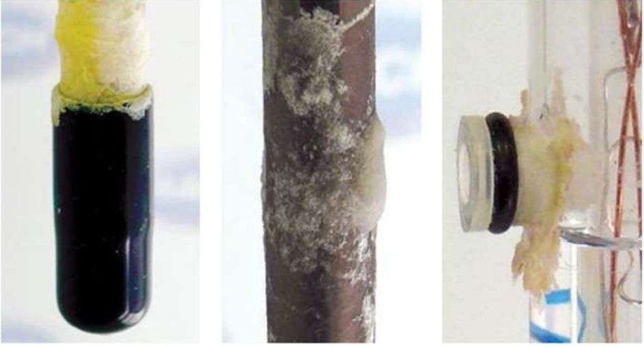
Şekil 5. pH probu saklama kapağı, elektrot gövdesi ve dolum deliğinde kristalleşme (Anonim, 2024c).
