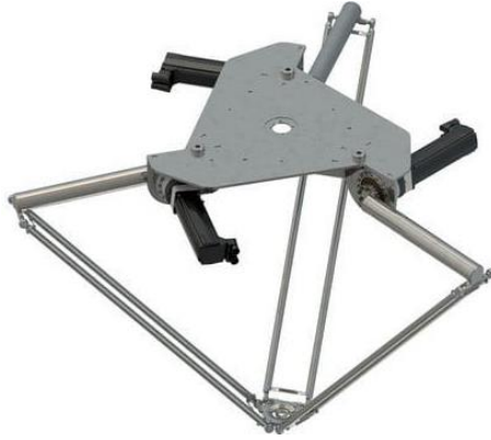
Şekil 2.1. Paralel delta robotun 3D modeli [Schneider Electric, 2023].
